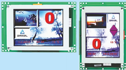
TFT LCD نمایشگر پخش موسیقی و اعلان طبقه Tft LCD Display, Music and Announcement System for Lifts
